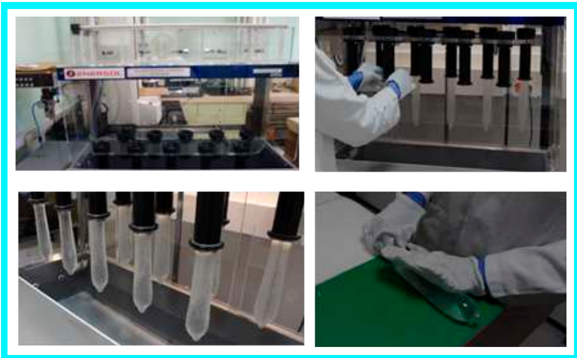
Ilustración 1. Ensayo de detección de orificios en preservativos
