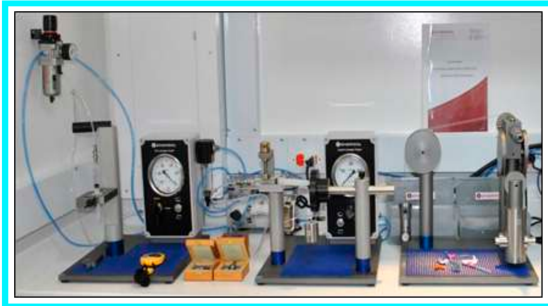
Ilustración 3. Ensayo de fugas de líquido y aire en jeringas
