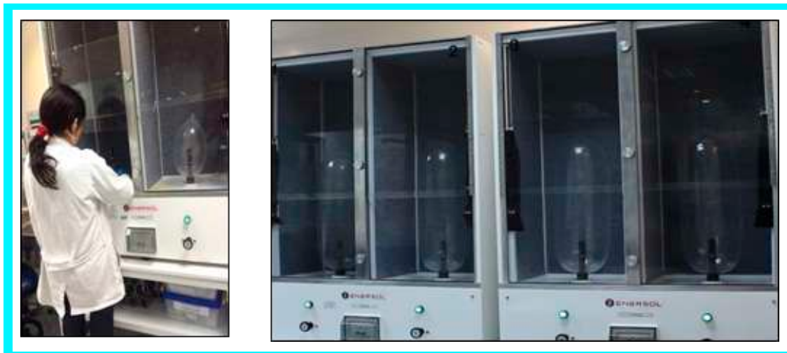
Ilustración 2. Ensayo de volumen y presión de estallido en preservativos
