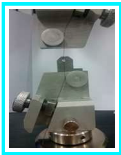
Ilustración 6. Ensayo resistencia a la tensión en suturas
