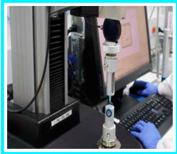
Ilustración 4. Ensayo unión entre el cono y la aguja en jeringas
