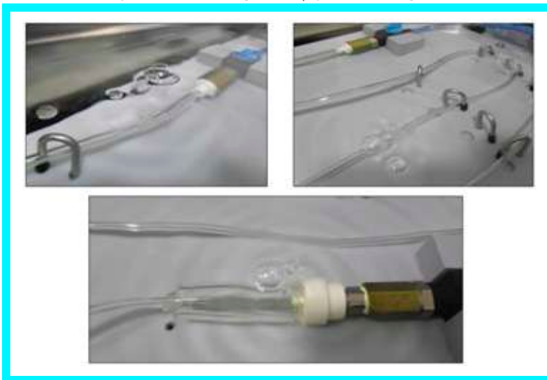
Ilustración 5. Ensayo detección de fugas en equipos de macrogoteo
